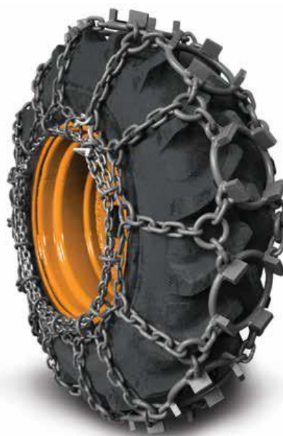
Вариант с 12 ринга на верига (по 2 халки между два ринга) - с опъващ синджир
