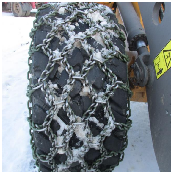
Вериги TWIST - без шпайкове - монтирани на гумите на челен товарач Volvo
