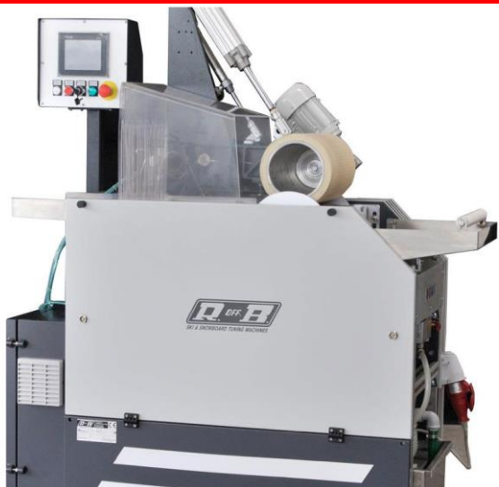
5 NR-35 Шлайфмашина за обработка базите на ски и сноуборд с камък, с възможност за направа на структура
